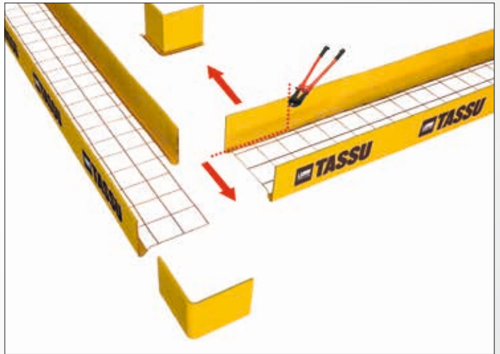
Po wykonaniu i oznaczeniu pomiarów osi formy, można rozpocząć montaż zgodnie z instrukcją.
